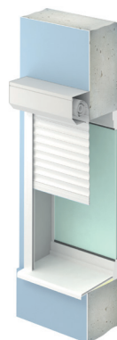
Накладной монтаж, короб наружу
