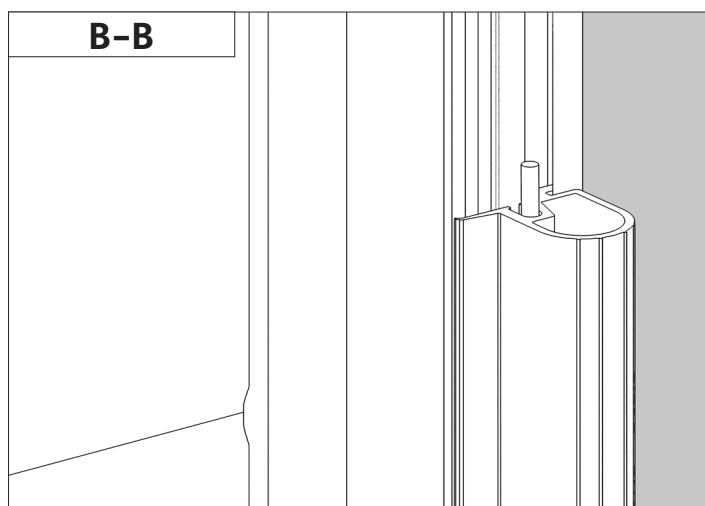
Схема прокладки кабеля обогрева в уплотнителе полотна.
